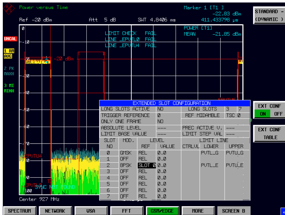
Bild 2-14: Extended Slot Configuration "Dynamic" - falsches Pegelprofil
