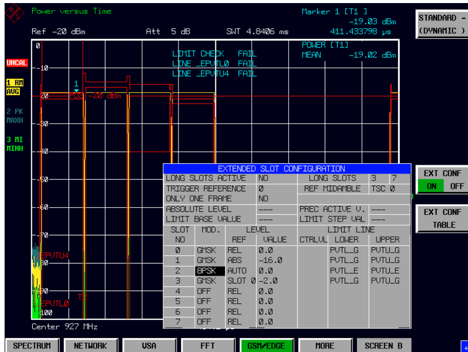
Bild 2-15: Extended Slot Configuration "Dynamic" - falsches Pegel
